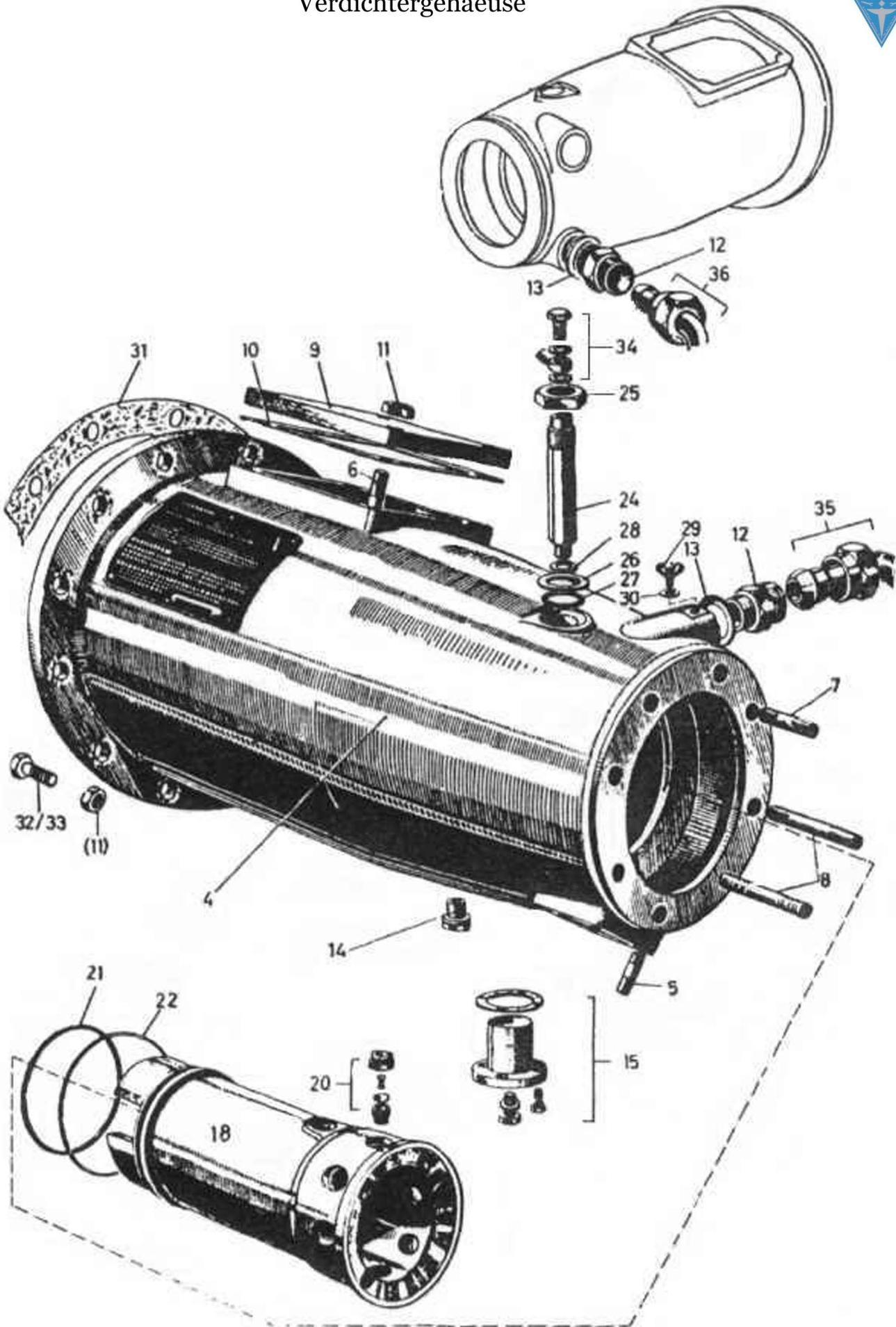
**Verdichtergehäuse Stufe 2 und 3** \* in Abbildung nicht dargestellt
